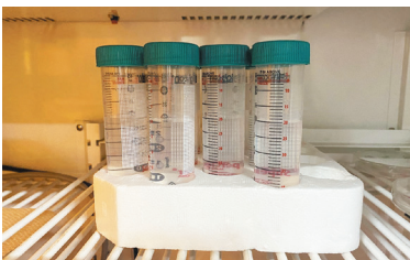
常温常圧で体内に近い状態を再現し、アパタイトを合成する実験の様子
